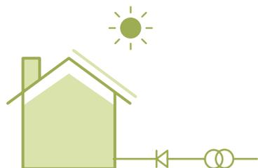
Instalaciones de autoconsumo conectadas a la red de distribución o transporte que disponen de un sistema antivertido, impidiendo la inyección de energía eléctrica excedentaria a la red de transporte o distribución.
